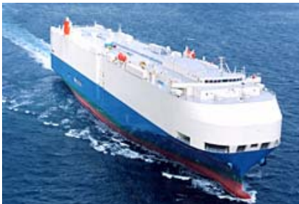
写真①風圧抵抗を削減した省エネルギー船
