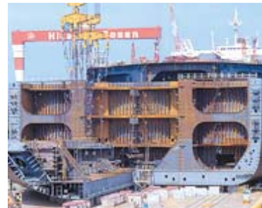
写真③ダブルハル（二重船殻）構造
