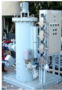
写真②バラスト水処理実験
