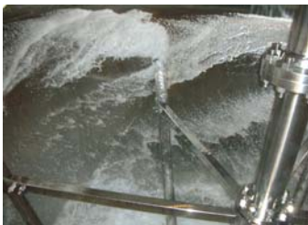
【容積40m 3 のウォールウェッター】 水運転中
