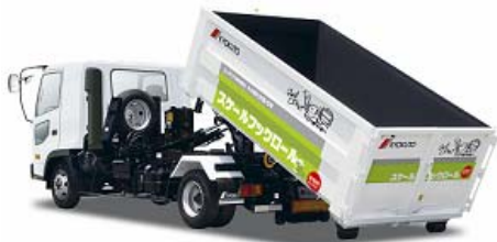
写真① 廃棄物回収を効率化し、即時計量可能なスケールフックロール
