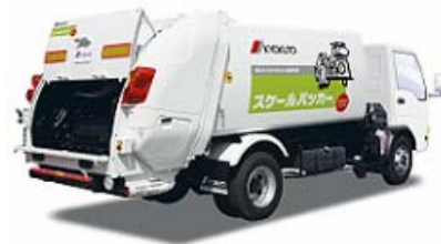
写真② 回収した廃棄物の計量が可能なスケールパッカー
