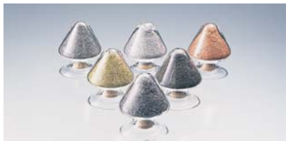
写真①耐熱性・耐摩耗性・高熱伝導性をもち、アスベストに替わるブレーキ摩擦材として広く使用されているメタルファイバー（金属短繊維）
