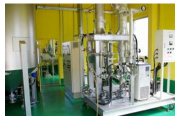
写真②バイオディーゼル燃料製造プラント
