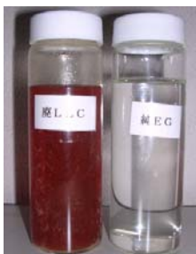
回収した廃 LLC(左)と 処理後の再生エチレングリコール(右)
