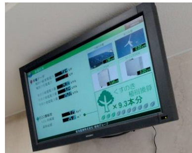
太陽光・風力発電量と社内の電力使用量のリアルタイム見える化システム
