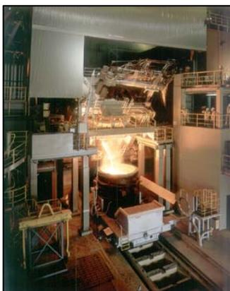
鉄を再生する電気炉
