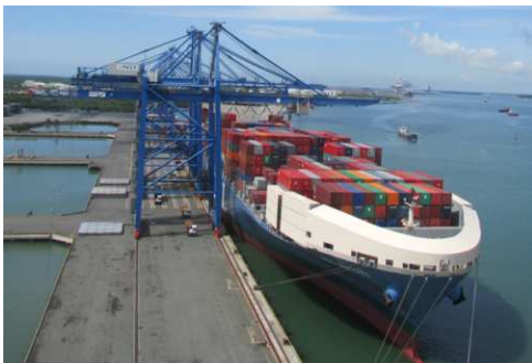
風圧抵抗を低減する風防を備えたコンテナ船
