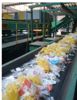
選別ライン （家庭から排出される容器包装 プラ類の選別を行うライン）
