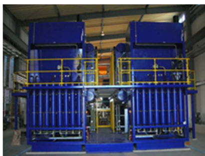
パレット成形機 （選別・洗浄・減容後の再生樹脂を原料 としたパレット製造のための成型機）
