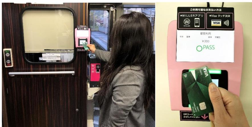
本サービスは、均一運賃(1回券、1日券等)だけでなく、車両のGPSを活用することにより距離制運賃(距離に基づき変動する運賃)の決済も可能にしています。また、海外では広く利用されている鉄道の Visa のタッチ決済の仕組みに、日本国内で求められる高速処理のニーズに対応したシステムを導入しており、スピーディーに決済が完了します。
