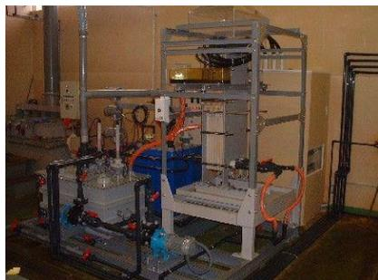
エッチング液の電解再生装置
