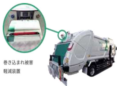
巻き込まれ被害軽減装置付車両 AI による技術で危険を察知
